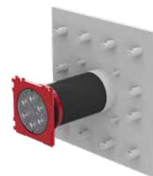
Zur Einführung von Kabeln bzw. Anbindung von Kabelschutzrohren in Gebäude mit Dichtbahnen oder zugelassenen kunststoffmodifizierten Dickbeschichtungen (PMBC). Mit der Fest-/Losflansch-Konstruktion wird ein Übergang von der Gebäudeabdichtung zur Durchführung hergestellt. Die Abdichtung erfolgt nach DIN 18533 (schwarze Wanne).
