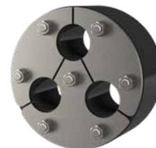
Individuelle Ringraumdichtung in geschlossener oder geteilter Ausführung zur Abdichtung von neu zu installierenden oder bereits verlegten Kabeln. Die Dichtung wird entsprechend kundenspezifischer Maßvorgaben gefertigt - zum Beispiel exzentrisch, mit überdeckendem Flansch oder für Mehrfach- und Mischbelegung.
