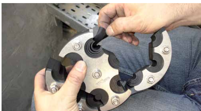
HRD150 SG 6x8-36 – Adattamento flessibile al diametro del cavo
