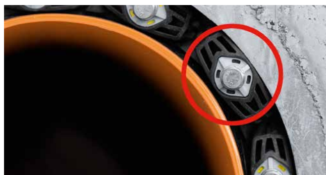
GKD con un segmento non serrato - Errore di montaggio subito individuato
