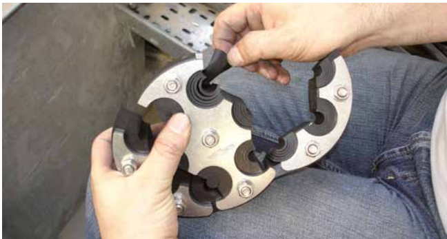
HRD150 SG 6x8-36 - flessibile adattamento ai diametri dei cavi
