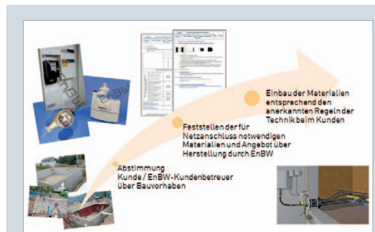
Bild: Vereinfachter Prozessablauf für die Auswahl einer Hauseinführung
