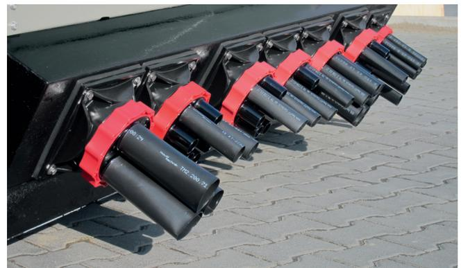
Die Flächenabdichtung aus Cloropren passt sich optimal der Gebäudeabdichtung der Wechselrichterstation an. Durch die KTL-Beschichtung der Aluminium-Dichtfl ansche wird ein optimaler Korrosionsschutz erreicht. Die Abdichtung zu den Kabeln erfolgt mit Thermomuffen (Warmschrumpftechnik). Unbelegte Stutzen werden mit Verschlussstopfen verschlossen.
