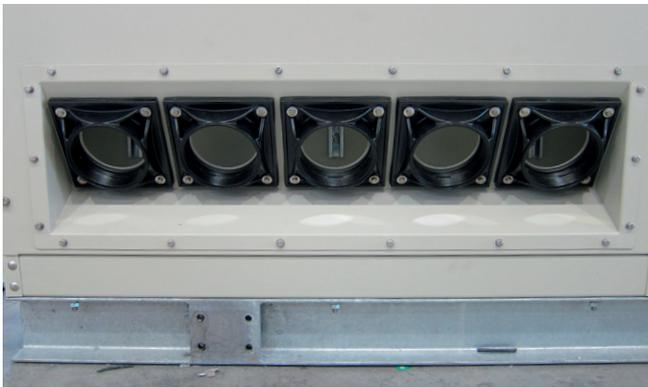
Die Dichtfl ansche HSI 150-DF können entsprechend der Kabelbelegung über das Bajonettensystem mit Systemdeckeln bzw. Systemeinsätzen bestückt werden. Die Positionierung der Kabeldurchführungen erfolgt gemäß Kundenwunsch. Durch den Schrägeinbau der Dichtfl ansche im Stationsgehäuse können die Kabel auch unter Einhaltung der Mindestbiegeradien optimal verlegt werden.
