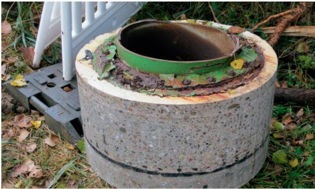
Bohrkern der 800 mm großen Kernbohrung mit alter Stahlleitung
