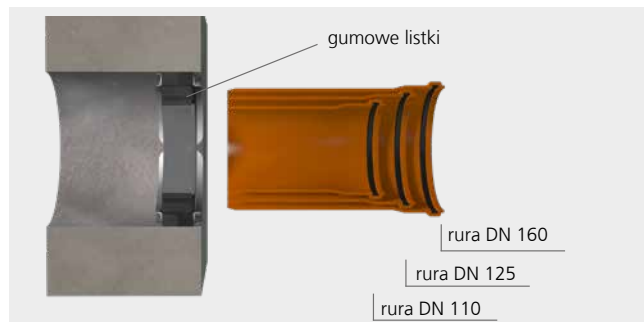
Uniwersalne wkłady uszczelniające HSD200 SSG 1x110/125/135/160 b40 umożliwiają uszczelnianie standardowych rur kanalizacyjnych
