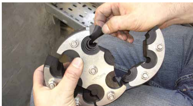
HRD150 SG 6x8-36 5 – system listków umożliwiający dopasowanie wkładu do średnicy kabla na miejscu montażu
