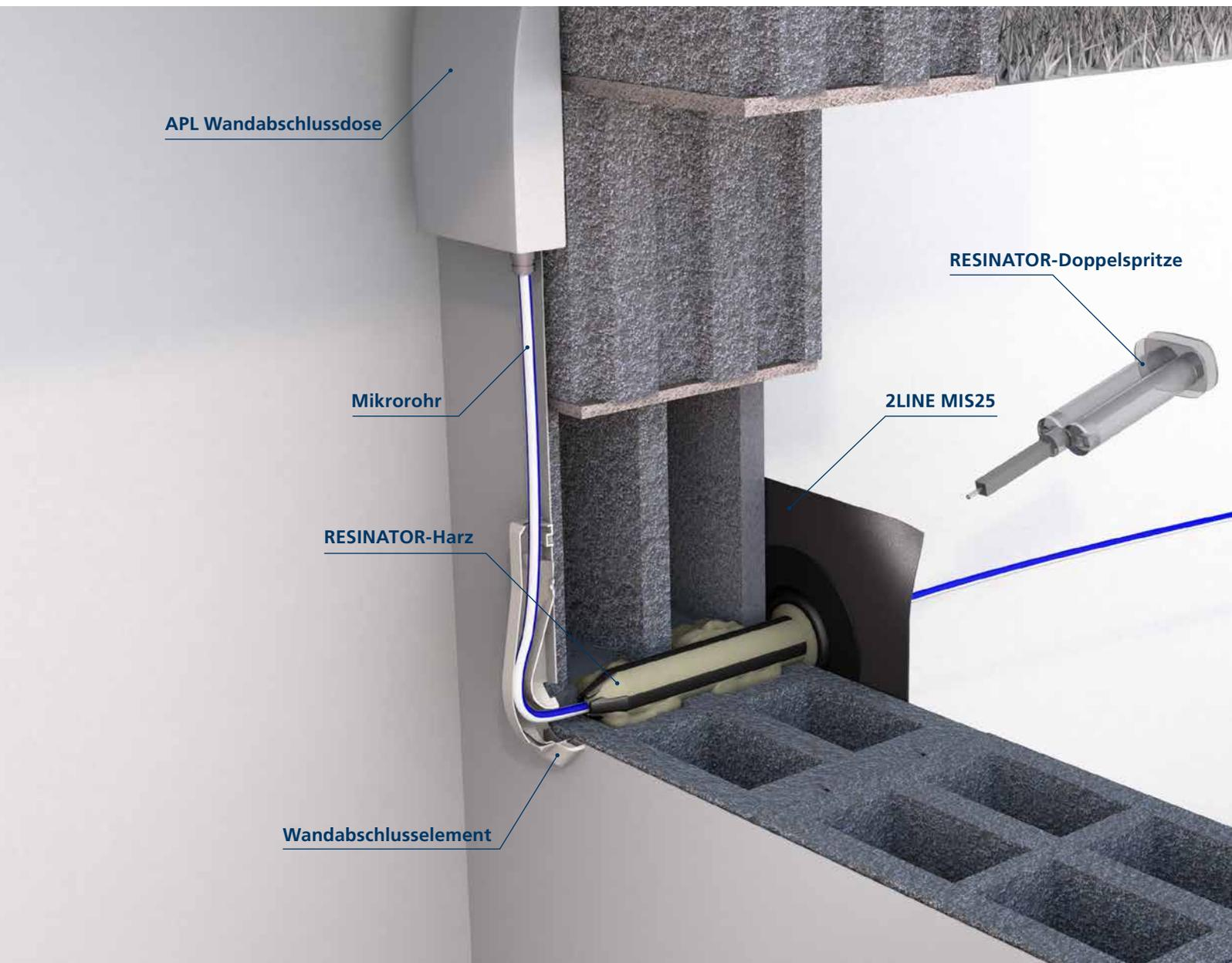
Der Glasfaserausbau schreitet immer schneller voran. Ein Anschluss an das Glasfasernetz gehört mittlerweile nicht nur bei Neubauten zum Standard, sondern ist auch für Bestandsgebäude die Möglichkeit für eine Anbindung an schnelles Internet. Zu einer zukunftsfähigen Sanierung gehört daher auch ein Glasfaseranschluss. Egal ob Ziegel, Betonhohlblockstein oder massiver Beton, mit der 2LINE MIS25 bietet Hauff-Technik eine Einzelhauseinführung für Glasfaserrohre für jede Wandart an.
