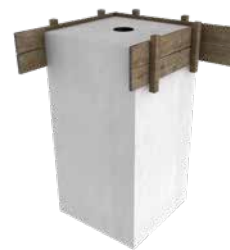
Fundament vor Ort betoniert
