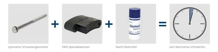
Die Kombination aus einer optimierten Schraubengeometrie, dem GKD-Spezialelastomer und dem Hauff-Gleitmittel ermöglicht, dass die Gliederkette bereits nach einmaligem Anziehen fertig montiert ist. Ihr Vorteil – keine Wartezeiten und kein zeitintensives mehrmaliges Nachziehen.
