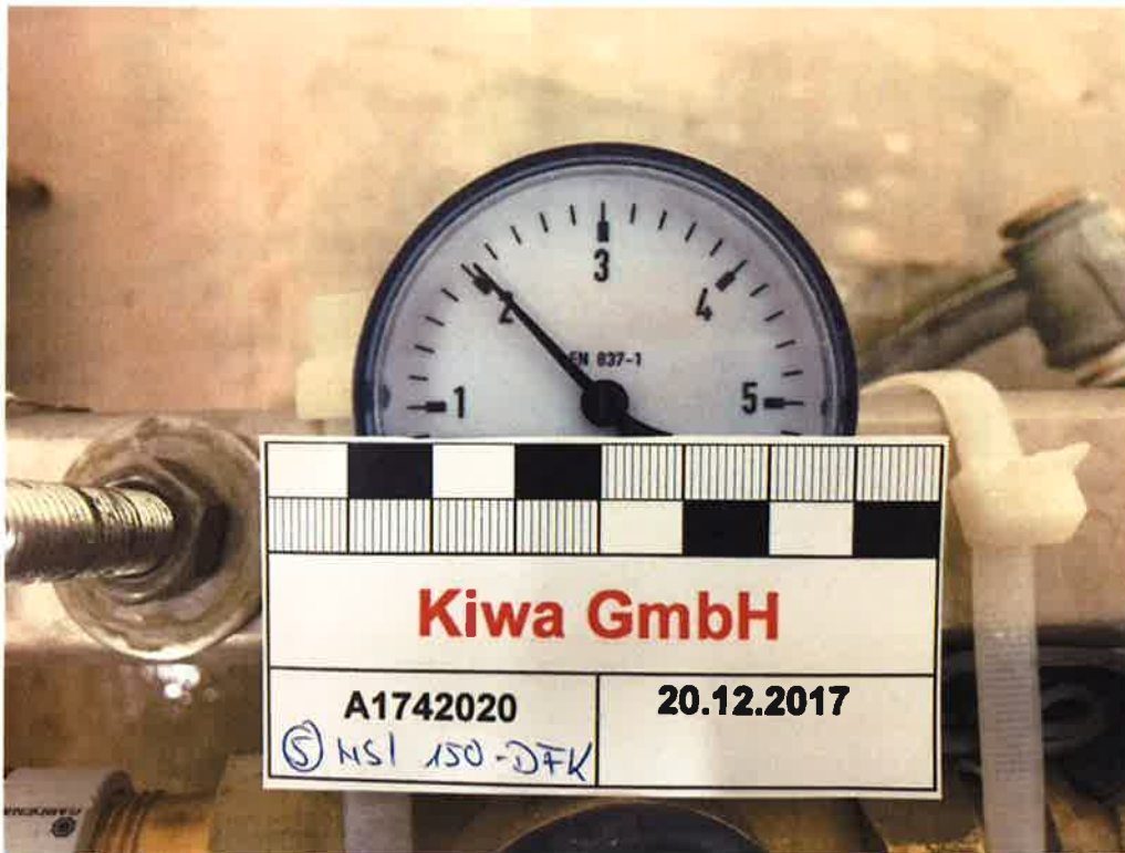
Abbildung A3. Druckdichtigkeitsprüfung der mit wassergefüllten Druckglocke bei einem Nenndruck von \geq 2 bar (Manometerstand bei Versuchsbeginn am 20.12.2017).
