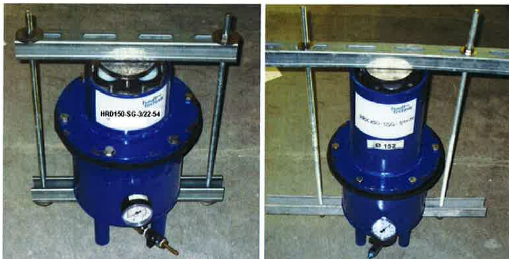
Abbildung 1. Angelieferte Versuchsaufbauten mit eingebauten Ringraumdichtungen HRD150-SG-3/22-54 (links) und HRK150-SSG-3/24-54 (rechts).
