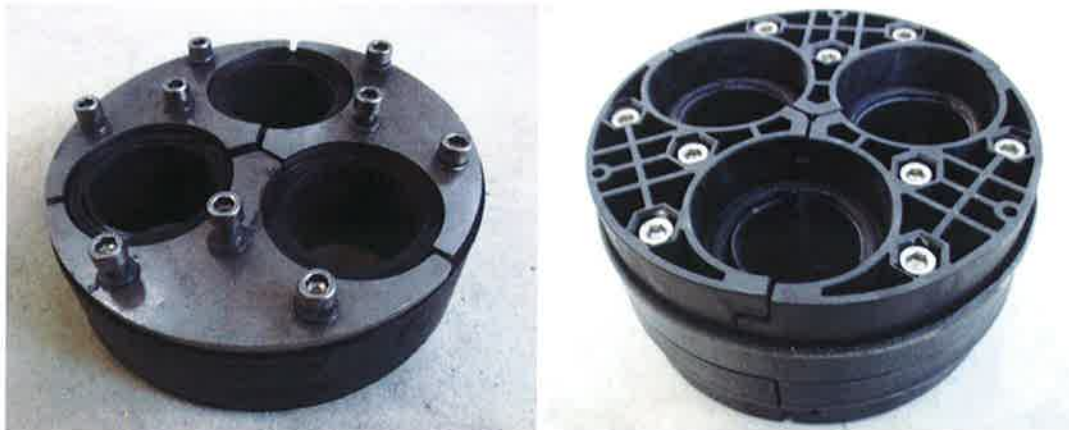
Abbildung 7. Ansicht der Oberseite der Ringraumdichtungen nach Ausbau aus den Druckbehältern (links: HRD150-SG-3/22-54; rechts: HRK150-SSG-3/24-54).
