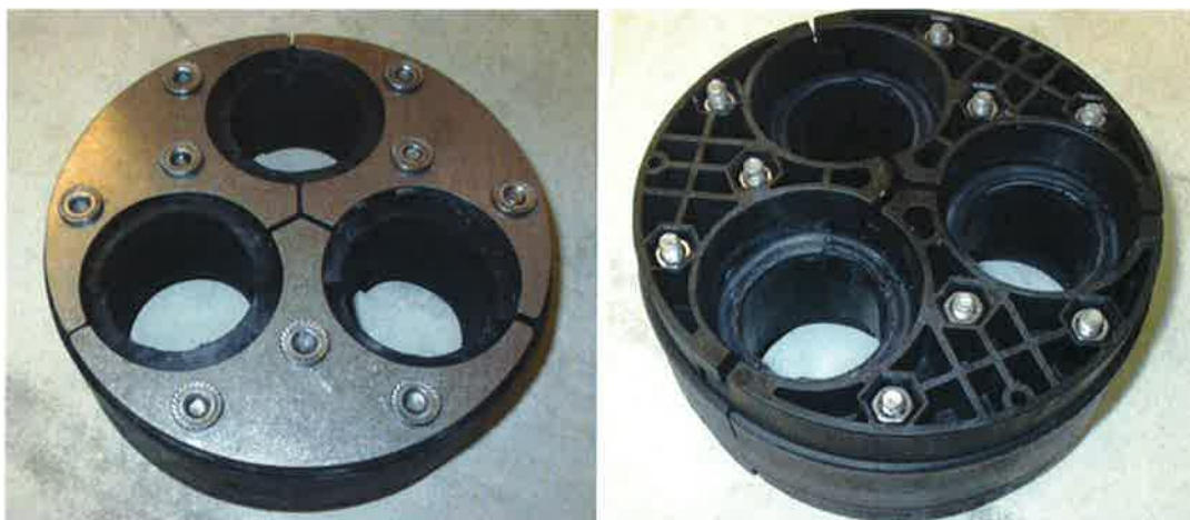
Abbildung 8. Ansicht der Unterseite der Ringraumdichtungen nach Ausbau aus den Druckbehältern (links: HRD150-SG-3/22-54; rechts: HRK150-SSG-3/24-54).
