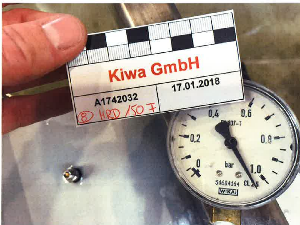
Abbildung A2. Druckdichtigkeitsprüfung der mit wassergefüllten Druckglocke bei einem Nenndruck von \geq 1 bar (Manometerstand nach 28 Tagen am 17.01.2018).
