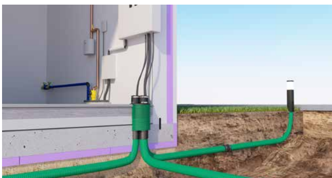
Eingebaute Hausausführung ETGAR Bauherrenpaket
