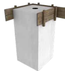
Fundament vor Ort betoniert
